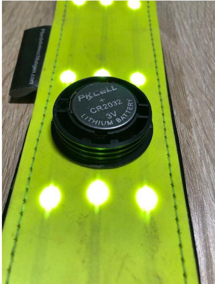
5. Nehmen Sie anschliessend den Deckel. Achten Sie bei diesem darauf, dass die Gummi-Dichtung im Innern vollständig flach am Boden entlangläuft.
