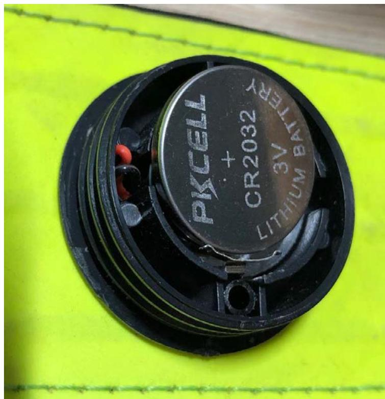
4. Drücken Sie die Batterien runter und achten Sie darauf, dass diese in der vorgegebenen Fassung bleiben. Beim Hinunterdrücken können Sie zudem mittels Funktionskontrolle prüfen, ob sich die LED's einschalten.
